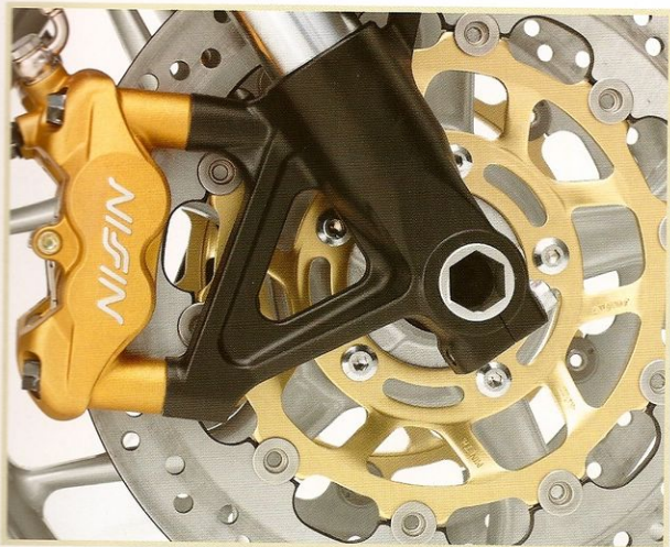
Pinze ad attacco radiale e dischi flottanti da 320mm. Un impianto frenante di prim'ordine.
