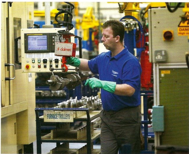
2006. L'albero motore di una Rocket è pronto per essere sottoposto al trattamento di indurimento a 520° per 28 ore in un forno speciale.
